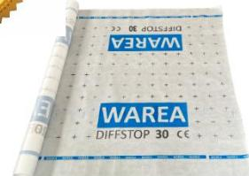
WAREA DIFFSTOP 30 ist eine gitterverstärkte, dreilagige, hoch reißfeste, transluzente Dampfbremse und Konvektionssperre für Wand-, Dach und Deckenkonstruktionen und wird in Verbindung mit diffusionsoffenen Schalungsbahnen verlegt. Speziell für Einblasdämmstoffe geeignet.
