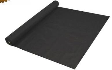
WAREA TITAN 280 MONO DSK ND ist eine erhöht regensichere, hoch diffusionsoffene, 2 lagige Schalungsbahn mit zwei wechselseitig angebrachten Klebestreifen für regensichere Unterdächer der neuesten Generation. WAREA TITAN 280 MONO DSK ND wurde speziell für den Einsatz unter Photovoltaikanlagen in Verbindung mit extrem hohen Temperaturen entwickelt und besitzt
