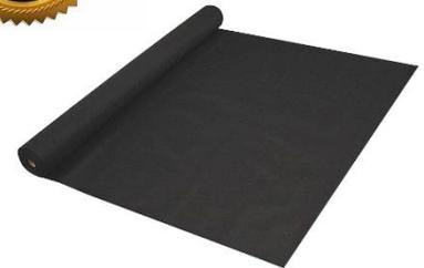
WAREA TITAN Fassadenbahn 280 DSK ist eine hoch diffusionsoffene, 2 lagige, UV beständige Fassaden- und Winddichtungsbahn für geschlossene und teiloffene Fassaden bis 50mm inklusive 2 wechselseitig angebrachten Klebestreifen.
